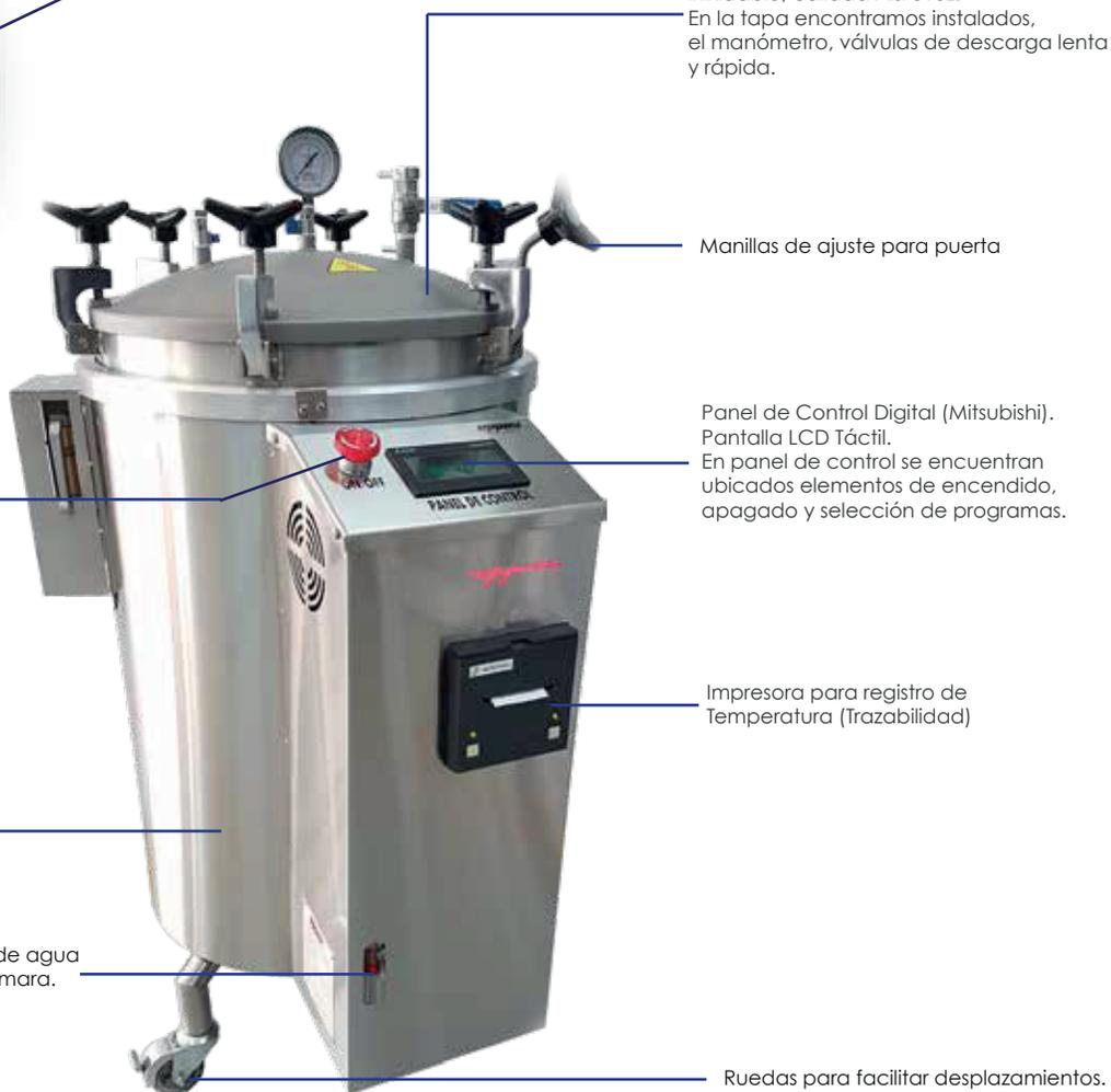
Construcción Cámara y Tapa en acero inoxidable, calidad Aisi 316L.
